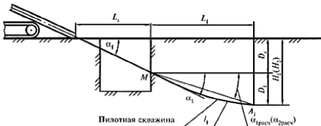
Рисунок Л.2 - Схема забуривания пилотной скважины
